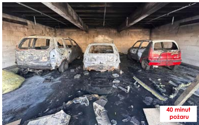
Test 2 – bez kontroli rozwoju mocy pożaru (bez działającej instalacji zraszaczowej i-Sprink)
