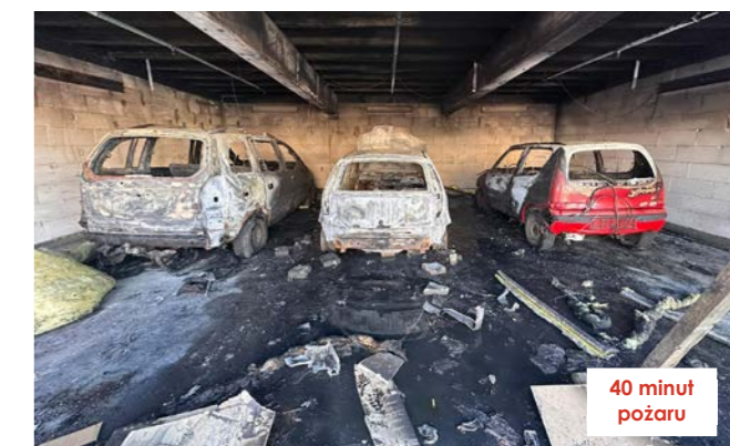
Test 2 – bez kontroli rozwoju mocy pożaru (bez działającej instalacji zraszaczowej)
